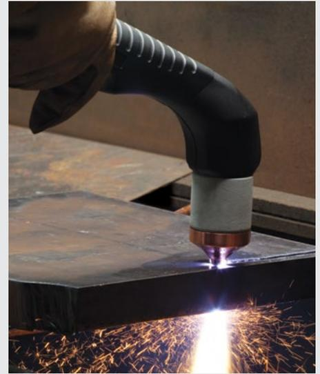
El sistema de corte por plasma MAXPRO200® logra velocidades de corte impresionantes, calidad de corte constante y una duración de los consumibles excepcional con gas plasma aire y oxígeno. Para una fácil operación, los parámetros de corte optimizados se asignan y controlan automáticamente en un único paso. Diseñado para el corte mecanizado y manual, y el ranurado, de uso industrial de gran capacidad, el MAXPRO200 ofrece un rendimiento confiable en un amplio rango de aplicaciones industriales.
